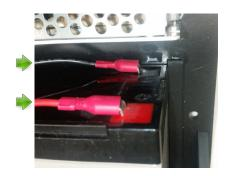
FR ■ Dans le boîtier « BATTERY BACKUP », branchez le câble TTK bus 8723 en utilisant le code couleur suivant :
