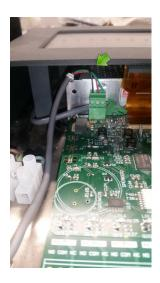
FR Dans la centrale numérique FG-NET, retirez le connecteur d'alimentation 3 points provenant de l'alimentation intégrée et remplacez-le par le câble TTK 8723 que vous venez d'installer, en utilisant le même code couleur (un nouveau connecteur à 3 points est fourni).
